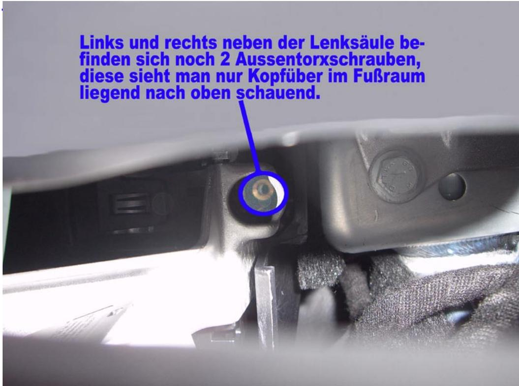
**Links und rechts neben der Lenksäule befinden sich noch 2 Aussen-torx-schrauben, diese sieht man nur Kopfüber im Fußraum liegend nach oben schauend.**
