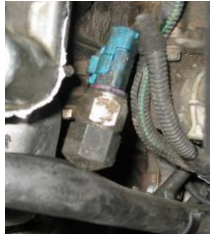
فشنگی روغن هیدرولیک موجود بر روی مدار هیدرولیک فرمان
