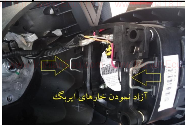
شکل دو : آزاد نمودن خارهای ایربگ
