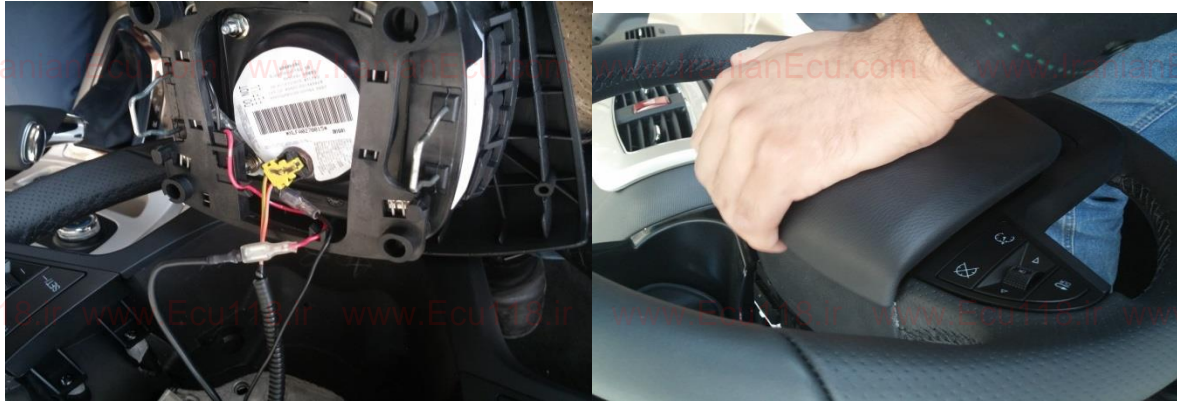
شکل شش: اتصال مجدد کانکتورهای پشت قاب فرمان و نصب ایربگ
