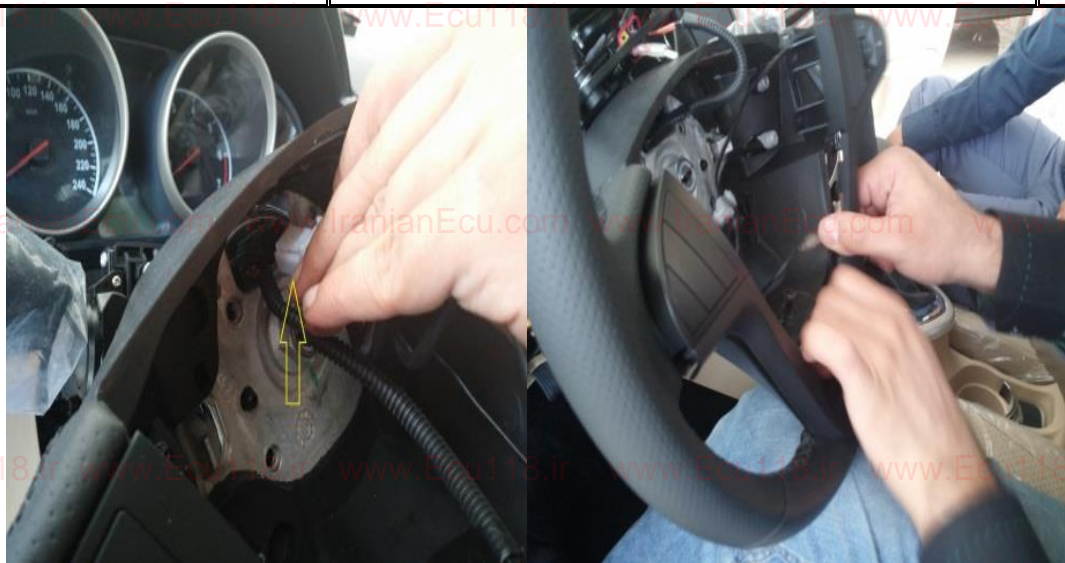
شکل چهار : باز نمودن همزمان قاب کلیدها
