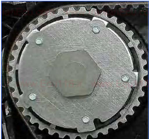
این وسیله برای ایجاد فاصله زمانی مفید بین حرکت میل بادامک و باز و بسته شدن سوپاپ بکار می‌رود. پولی تایمینگ روی VVT ثابت می‌باشد.
