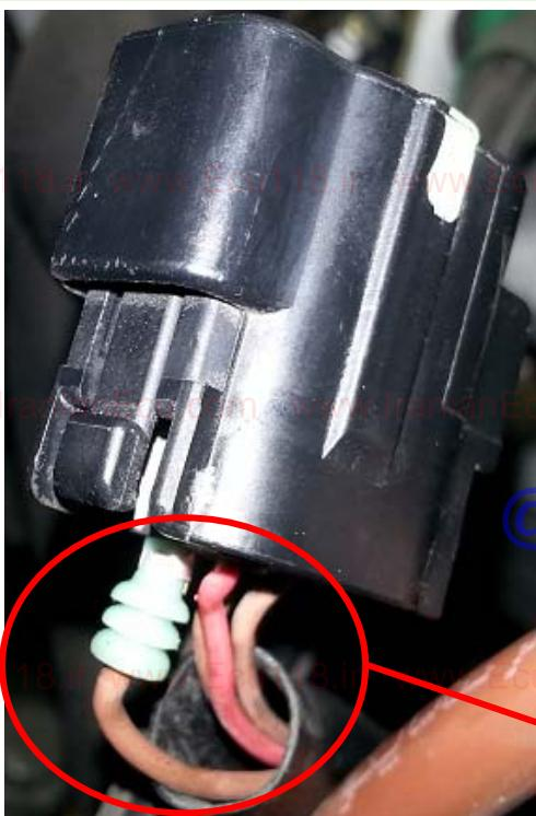
۱- بدليل احتمال جانمایی نامناسب دسته سیم موتور در فضای قرارگیری، ممکن است سیم شاخه اتصال به سنسور اکسیژن در وضعیت کشیده باشد و باعث بیرون آمدن سیم از سوکت گردید.
