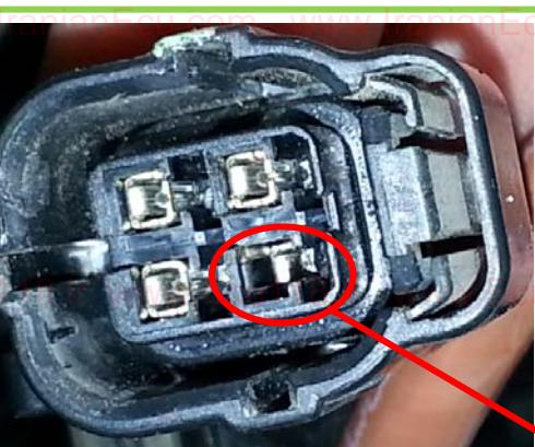
۲- وضعیت پینهای کانکتور اکسیژن سنسور واقع در دسته سیم از لحاظ اتصال کامل به پینهای سوکت سنسور اکسیژن دقیقاً "کنترل گردد تا ایراد Loss Connection نداشته باشدند.
