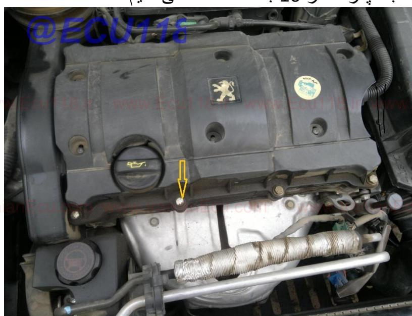
پس از باز کردن قالپاق ها شروع به باز کردن دو عدد نیم تنه های بالایی میل سوپاپ میکنیم که هر کدام دارای 10 عدد پیچ هستند که با بکس شماره 8 باز میشوند.
