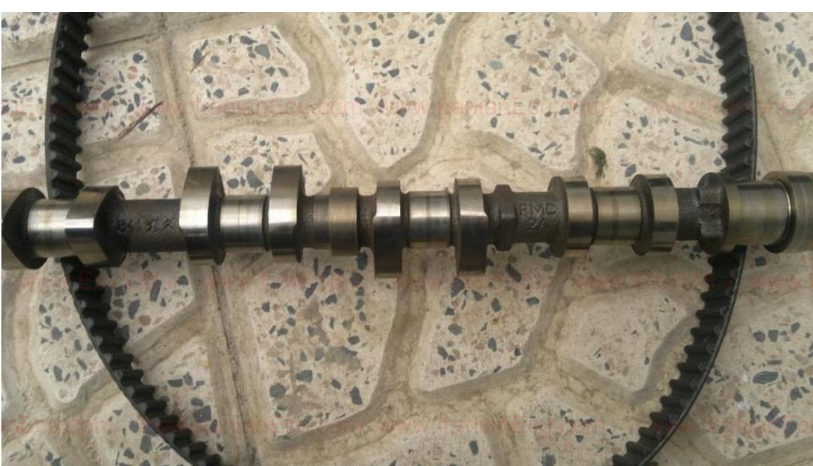
پس از باز کردن نیم تنہ ها میل سوپاپ هارا درمی اور یعنی میل سوپاپ دود و هوا مقاومت هستند و به طور اشتباه جا نمیروند
