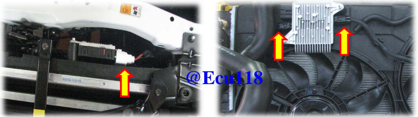
۳- پس از روشن کردن موتور، با فشردن دکمه A/C کولر، عملکرد فن های رادیاتور را بررسی نمایید.
